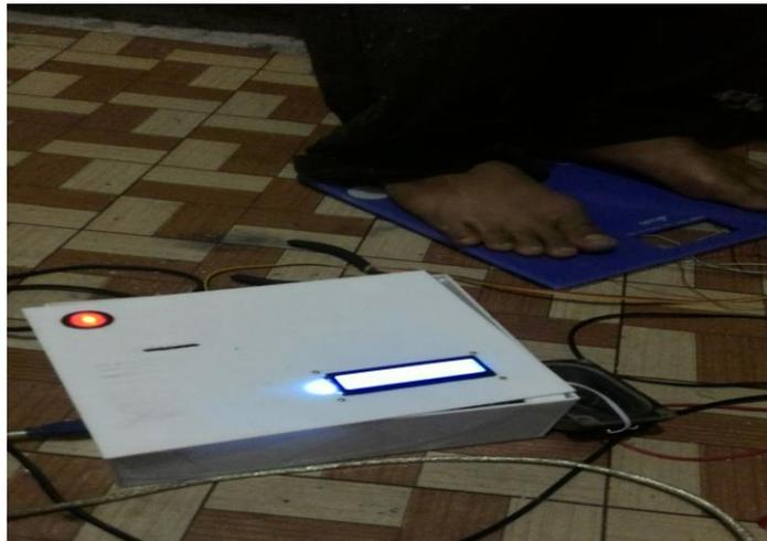
Gambar 10. Pengujian penimbangan secara langsung
